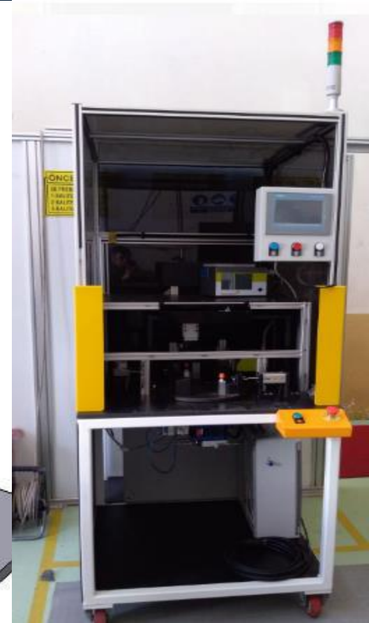
RENAULT BJA PROJECT KAPI KOLU POKA-YOKELİ MONTAJ BANKOSU Varlık , Pozisyon ve Montaj Kontrol Poka-Yokesi
