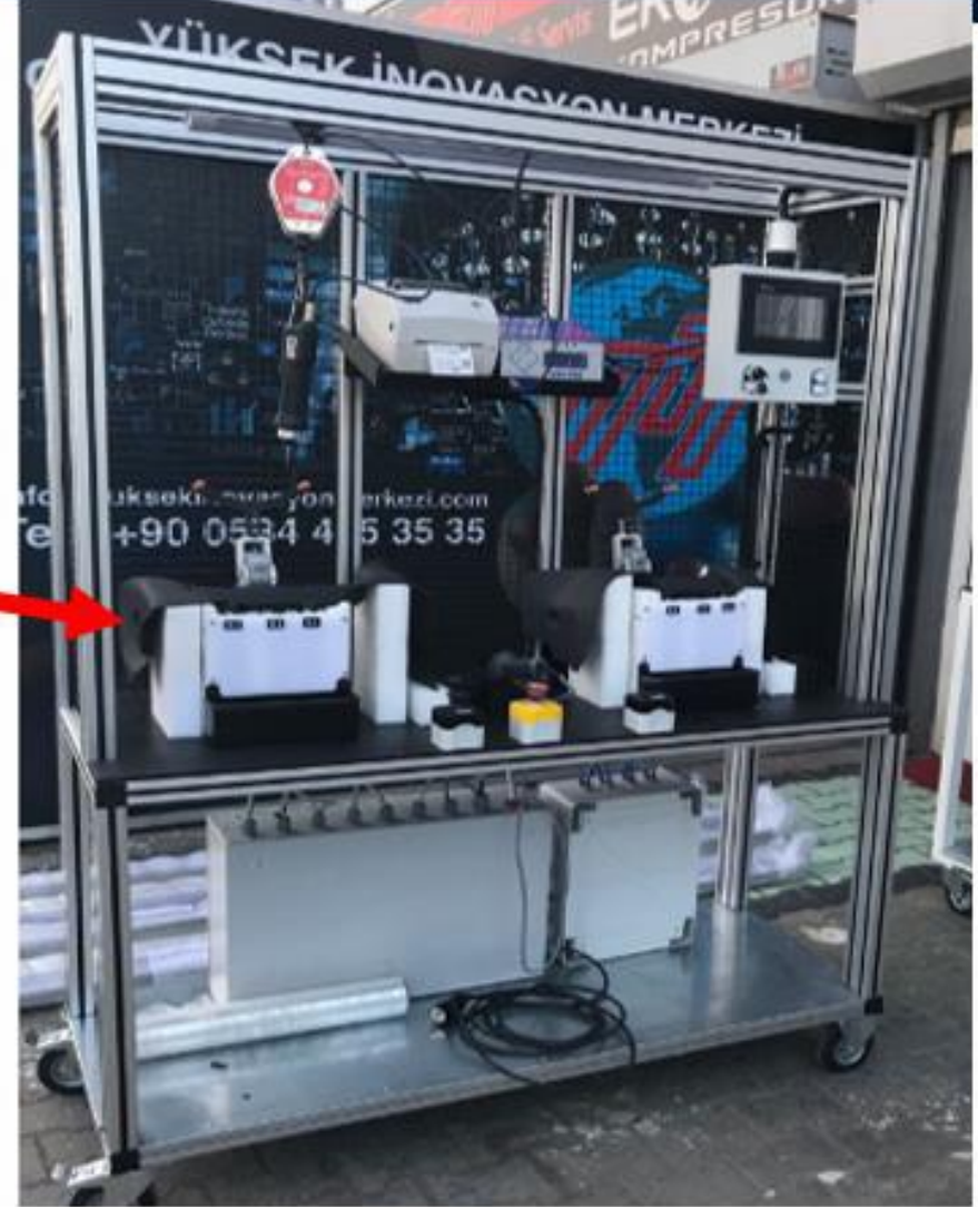
ELEKTRİKLİ SIKICILI VE BARKOD OKUYUCULU POKA-YOKE MASASI
