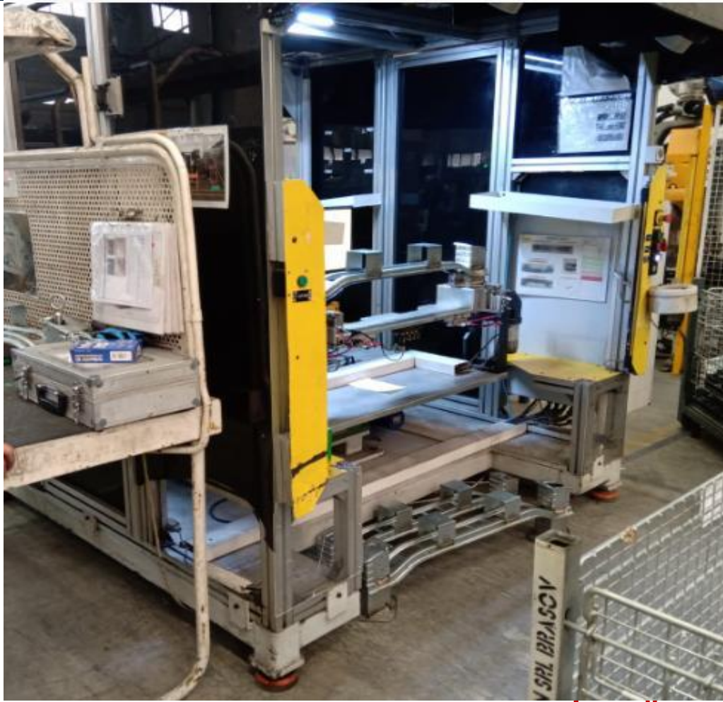
356 PROJECT ARKA TAMPON PERÇİN HÜCRESİ SERVO SİSTEMLİ VE KAMERA KONTROLLÜ PERÇİN MONTAJ VE KONTROL
