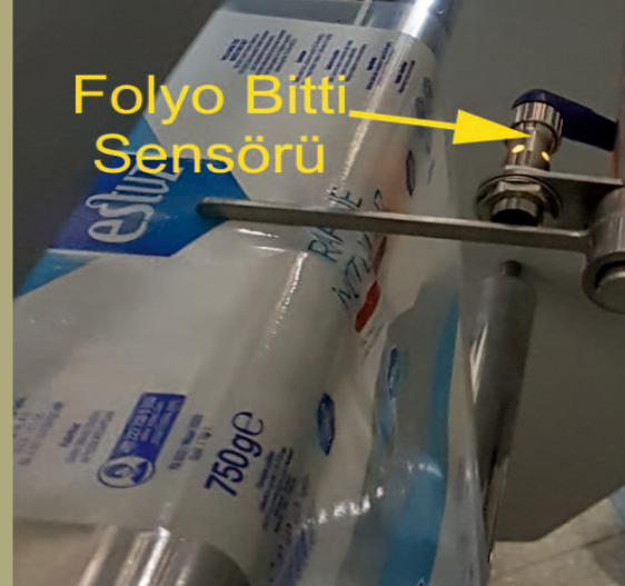
Folyo Bittiğini Algılar ve Makineyi Durdurur
