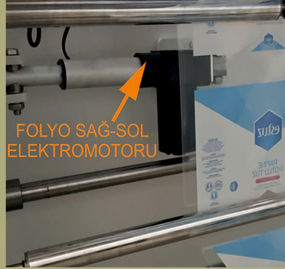
Elektromotorlu Bobin Standı Sağ-Sol Ayarı
