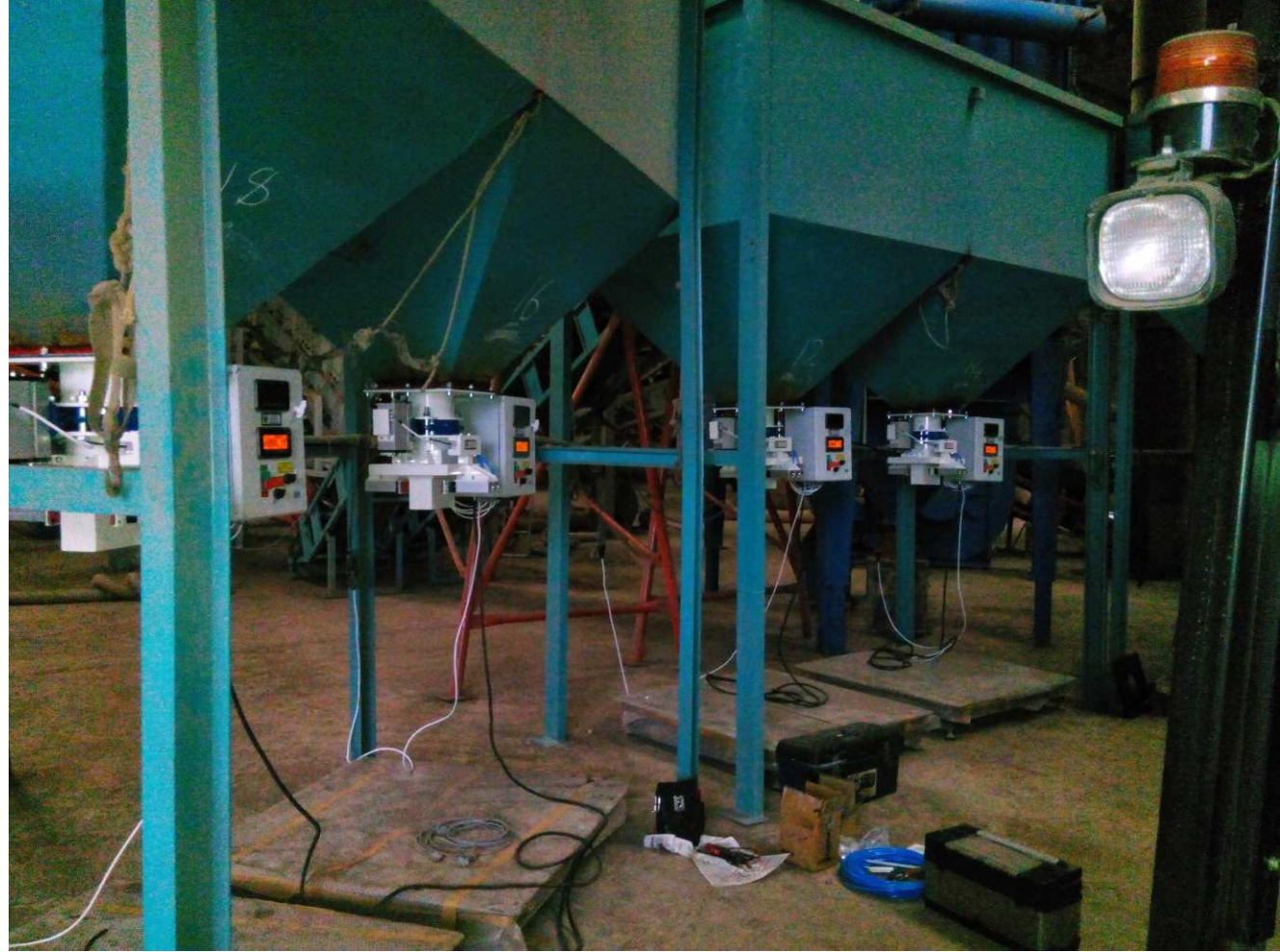
Maden Tozu için Serbest Akış Dolum Makinesi Uygulaması
