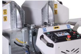
45 - 90° Otomatik Çift Kafa 45 - 90° Automatic Double Head
