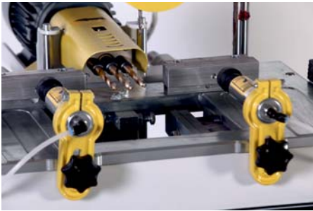
Birbirinden bağımsız çalışan matkaplar Running drills are independent of each other
