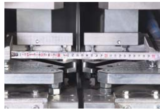
Minimum Kaynak Ölçüsü 29cm. Minimum Welding Measure 29 cm.
