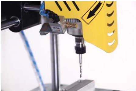
Soğutma sistemi Cooling system
