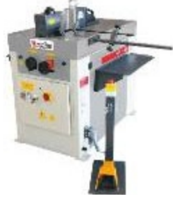
HP-40 Ağır Tip Sfero Döküm Tabla / HP-22 Sac Platine Tabla
