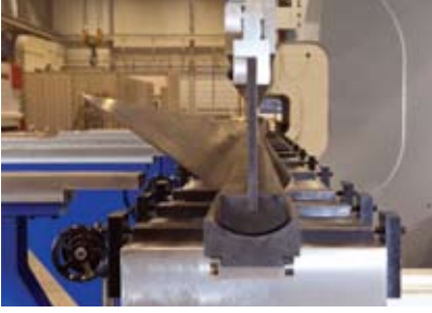
Abkant Pres Tandem 14200 mm x 1400 ton Press Brake Tandem 14200 mm x 1400 tons
