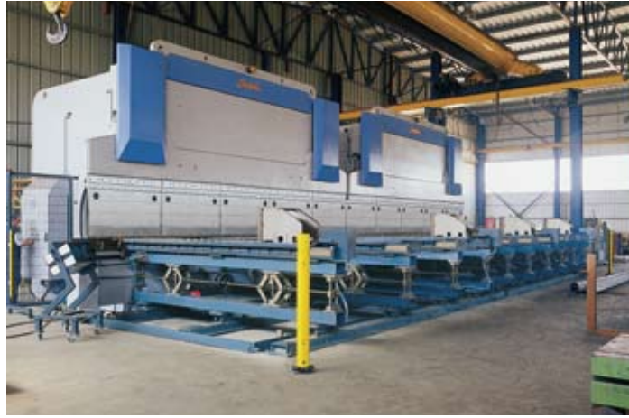
Abkant Pres Tandem 14200 mm x 1400 ton Press Brake Tandem 14200 mm x 1400 tons
