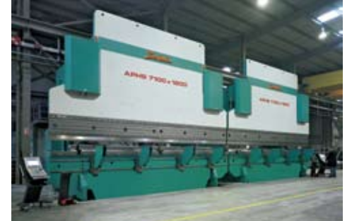
Abkant Pres Tandem 14200 mm x 2400 ton Press Brake Tandem 14200 mm x 2400 tons
