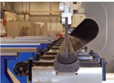
Abkant Pres 8100 mm x 1000 ton Press Brake 8100 mm x 1000 tons
