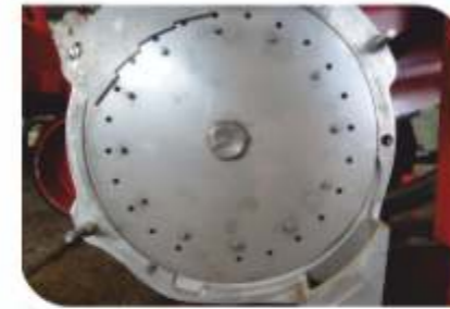
Ekim Düzgünlüğünü İzleme İmkânı Veren Pencereleler, Ekim Diskine Destek Diski, Hasas Tohum Tekleme Sistemi / Seeding inspection windows, seeding disc support, precise mono seed mechanism
