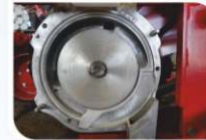
Ekim Düzensizliğini İzleme İmkânı Veren Pencereler, Ekim Diskine Destek Diski, Hasas Tohum Teklleme Sistemi / Seeding Inspection Windows, Seeding Disc Support, Precise Mono Seed Mechanism
