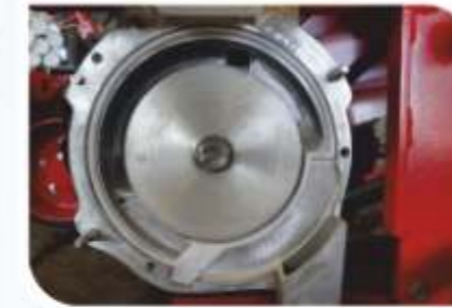
Ekim Düzgünlüğünü İzleme İmkânı Veren Pencereleler, Ekim Diskine Destek Diski, Hasas Tohum Tekleme Sistemi / Seeding inspection windows, seeding disc support, precise mono seed mechanism
