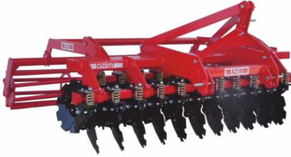
Opsiyonel Hidrolik Kontrollü Katlanır Merdane Optional Hydraulic Control / Folded Roller
