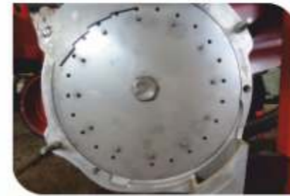
Ekim Düzensizliğini İzleme İmkânı Veren Pencereler, Ekim Diskine Destek Diski, Hasas Tohum Teklleme Sistemi / Seeding Inspection Windows, Seeding Disc Support, Precise Mono Seed Mechanism
