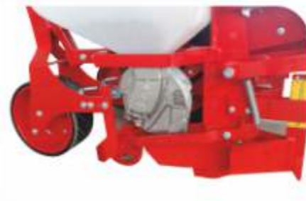
Her Koşulda Etkili Tohum Yatağı Hazırlamak için Bıçaklı Ön Küreme/Front Furrow Cleaner with Blade for best seed-bed clarification in all conditions.
