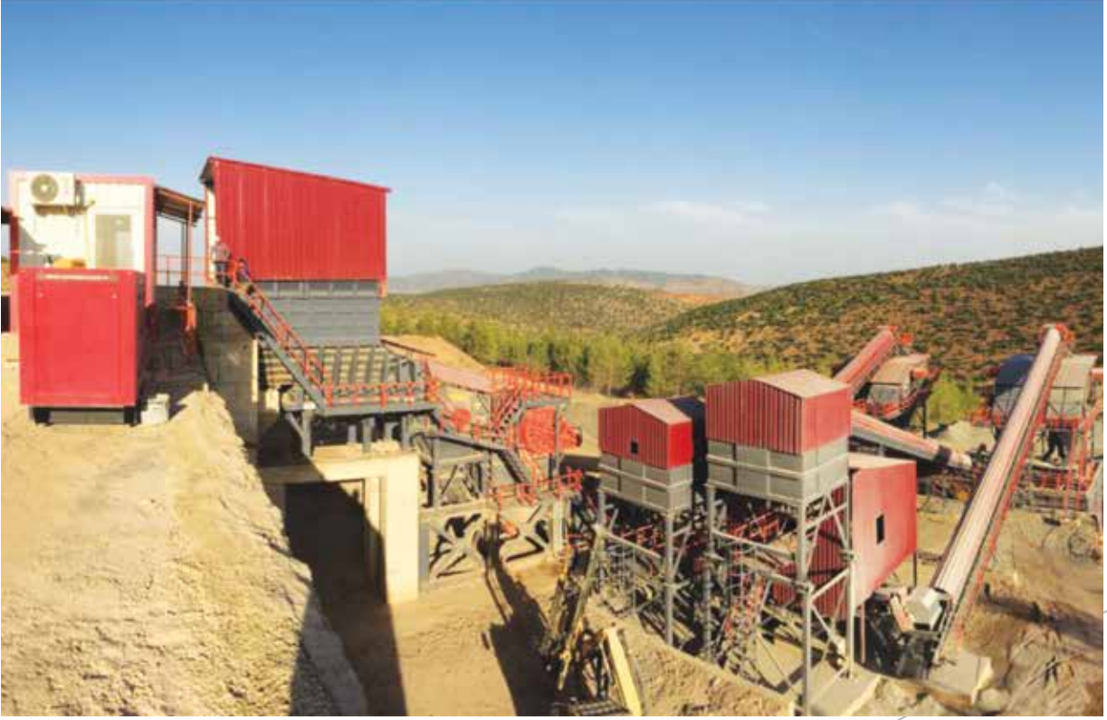
650 - 700 Ton Saat Kapasiteli Kırma eleme Tesisi - Kahramanmaraş 650 - 700 TPH Capacity Crushing & Screening Plant - Kahramanmaraş
