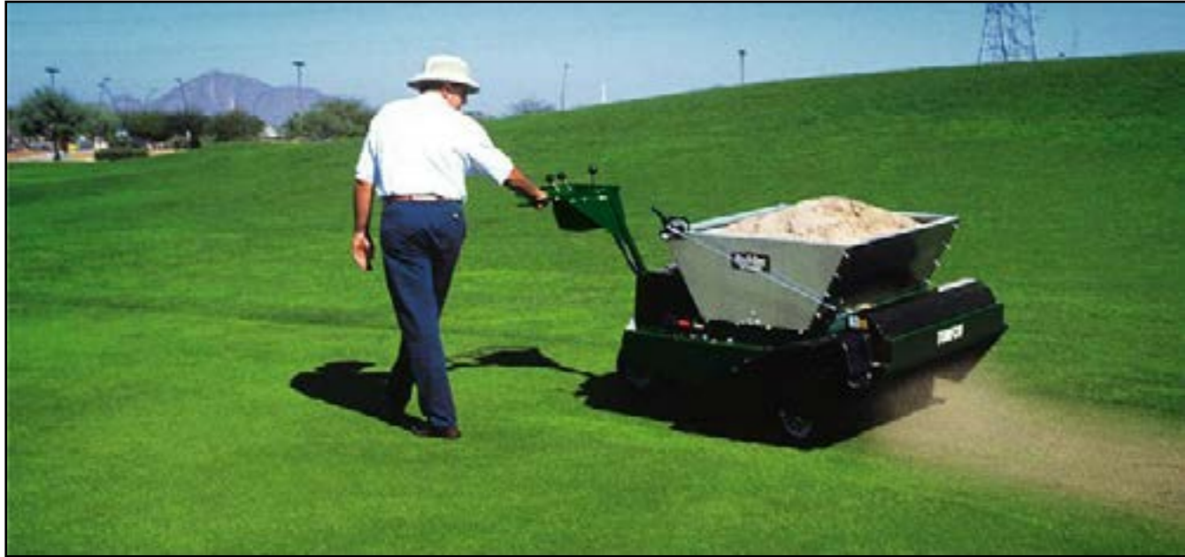
Golf alanları greenleri, futbol sahaları ve yeşil alanlar için profesyonel bir çim yüzey kum serme makinesi
