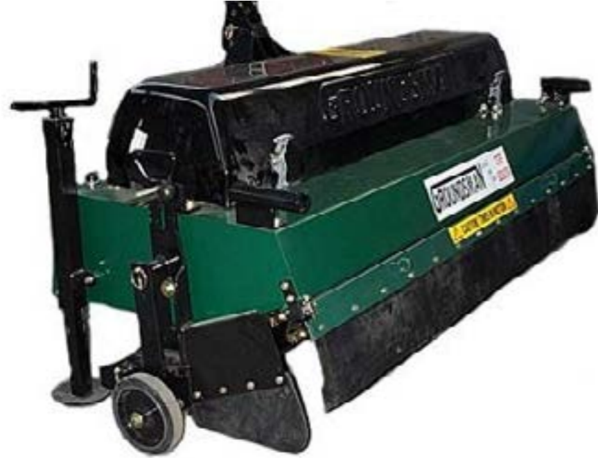
Golf sahaları ve futbol sahaları için traktöre monte edilen çim kök havalandırma makinesi
