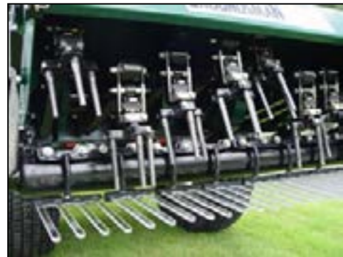
Golf sahaları ve futbol sahaları için traktöre monte edilen çim kök havalandırma makinesi
