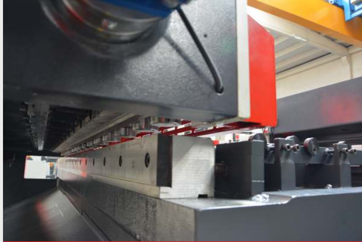
6 mm'den 20 mm'e Kadar Mükemmel Kesim Kalitesi ile Güçlü Monoblok Gövde
