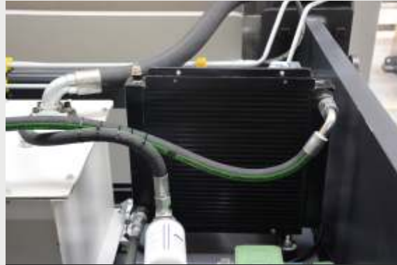
Hidrolik Yağ Soğutucu Sistemi
