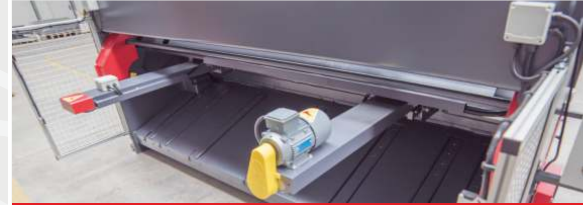
± 0,1mm hassasiyetli motorlu arka dayama
