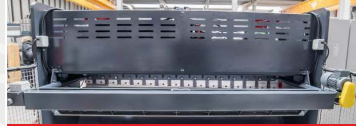
± 0,1mm hassasiyetli motorlu arka dayama
