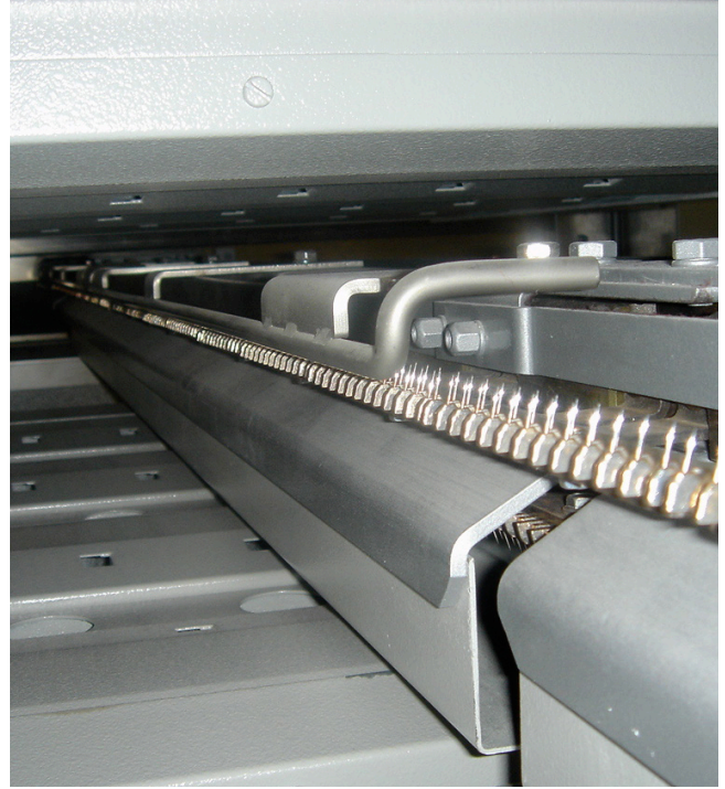
Kumaş Tutucu Bariyer Sistemi Fabric Holder Barrier System
