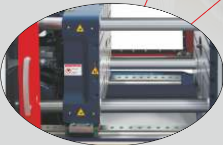
Mengene ve enjeksiyon grubunda hassas linear kızak sistemi. Precise linear guideways under clamping and injection unit.
