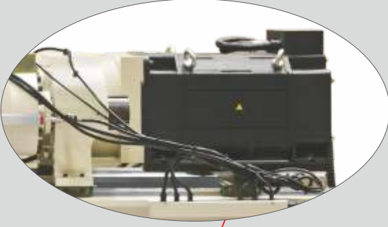
Direkt tahrikli elektrikli mal alma ünitesi. Direct-drive servo plasticizing unit.
