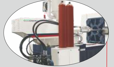
Özel ince cidar uygulamaları, akümülatör destekli hızlı enjeksiyon. Special thin-wall appliances, accumulator assisted high speed injection unit.
