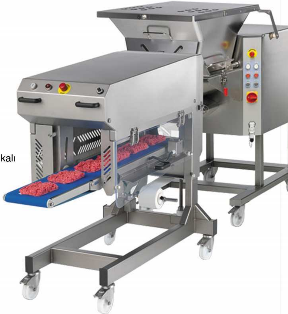
C/E 800 66 - 85Lt. Et Haznesi 1500 kg/Saat Standart: 5.5hp Opsiyonel: 7hp Kıyma Motoru
