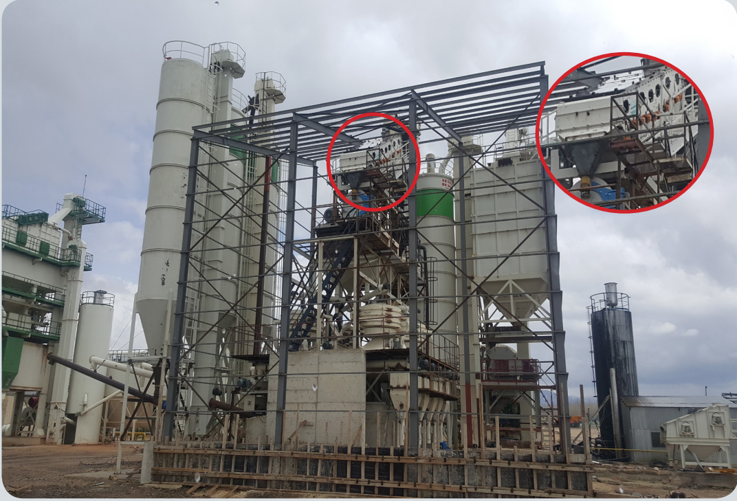
Bu tesiste; tek katlı 1500x6000 VCR-D elek makinası ile -0.710 mm 30 ton/saat yapı kimyasalı elenmektedir
