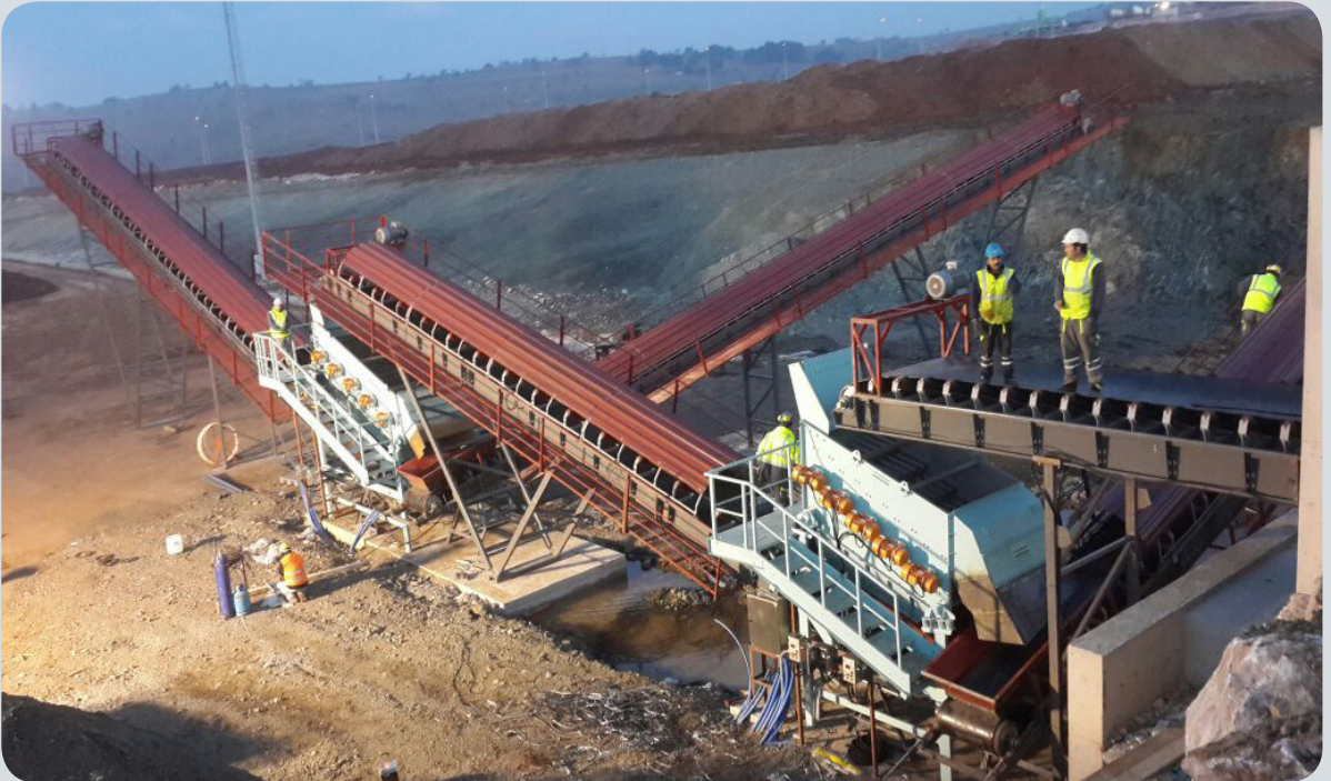
Bu tesiste; bir adet 1500x4000 VCR-D eleme makinası ile bir adet VCR ızgara ile -50 mm ölçülerinde 150 ton/saat yüksek nemli Kil elenmektedir.
