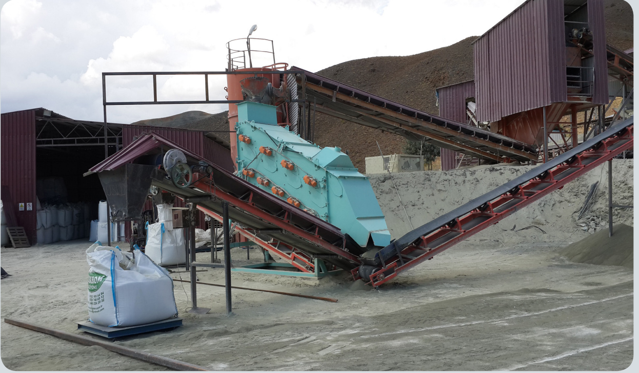
Bu tesiste; iki katlı 1000x3000 VCR-D elek makinası ile 200 mikron, 500 mikron 30 ton/saat Olivin elenmektedir.
