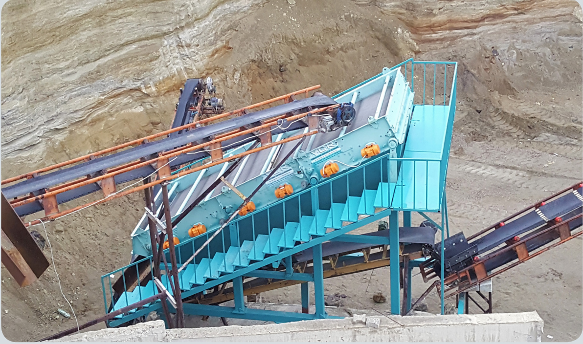
Bu tesiste; 20000x60000 VCR elek makinası ile 3 mm 100 ton/saat Olivin elenmektedir.
