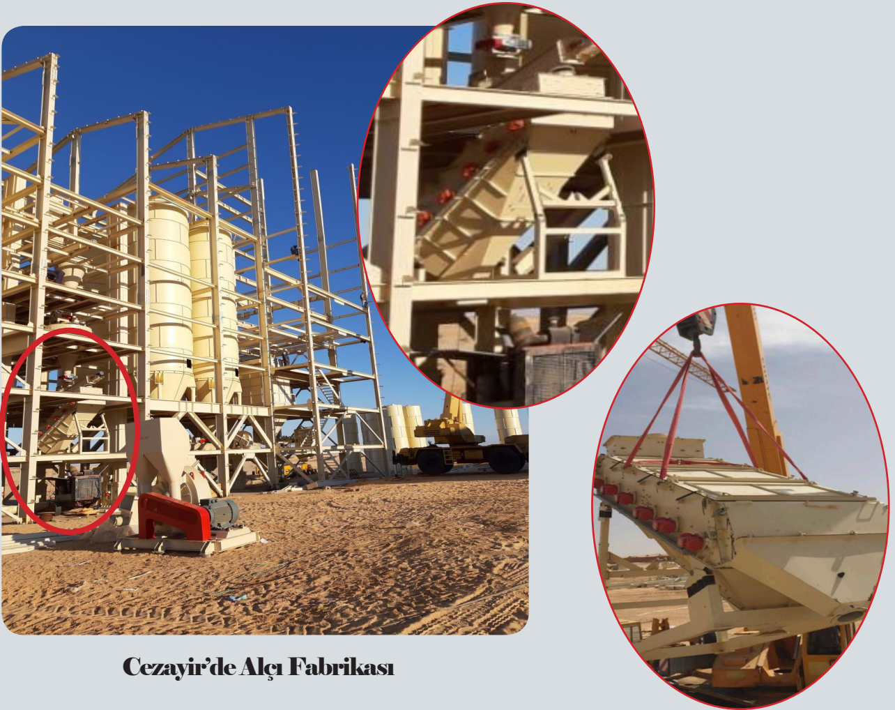
Bu tesiste; 20000x60000 VCR elek makinası ile 3 mm 100 ton/saat Olivin elenmektedir.
