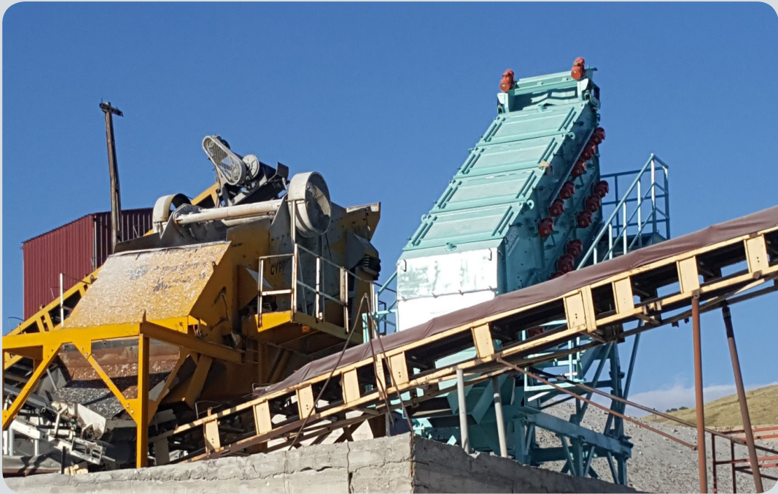
Bu tesiste; iki katlı 1500x6000 VCR-D eleme makinası ile 3 mm 5 mm ölçülerinde 100 ton/saat nemli Doğal Perlit elenmektedir.
