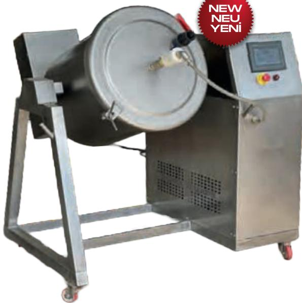
Der Vakuumbecher Typ ETDSK wird in den Größen von 300 - 1500 Liter produziert. Einstellbarer Arbeitswinkel, stufenlos einstellbare Drehzahl, Intervallvakuum sowie individuelle Steuerung sind nur einige der Vorteile dieser Maschine, die auch im Labor zum Einsatz kommen.
