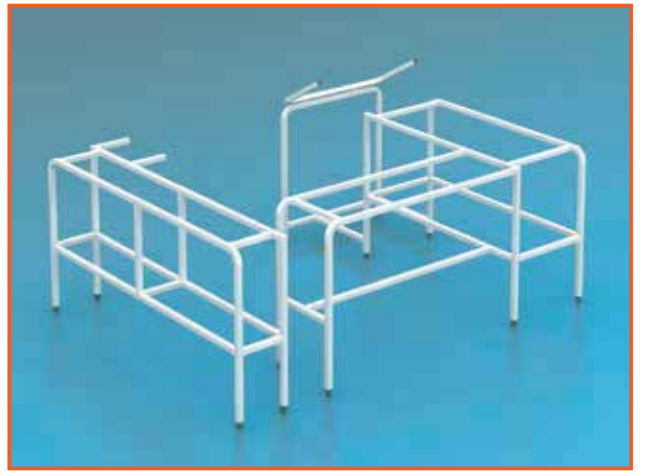
Makina tezgahı iskelet montajlı görünüşü
