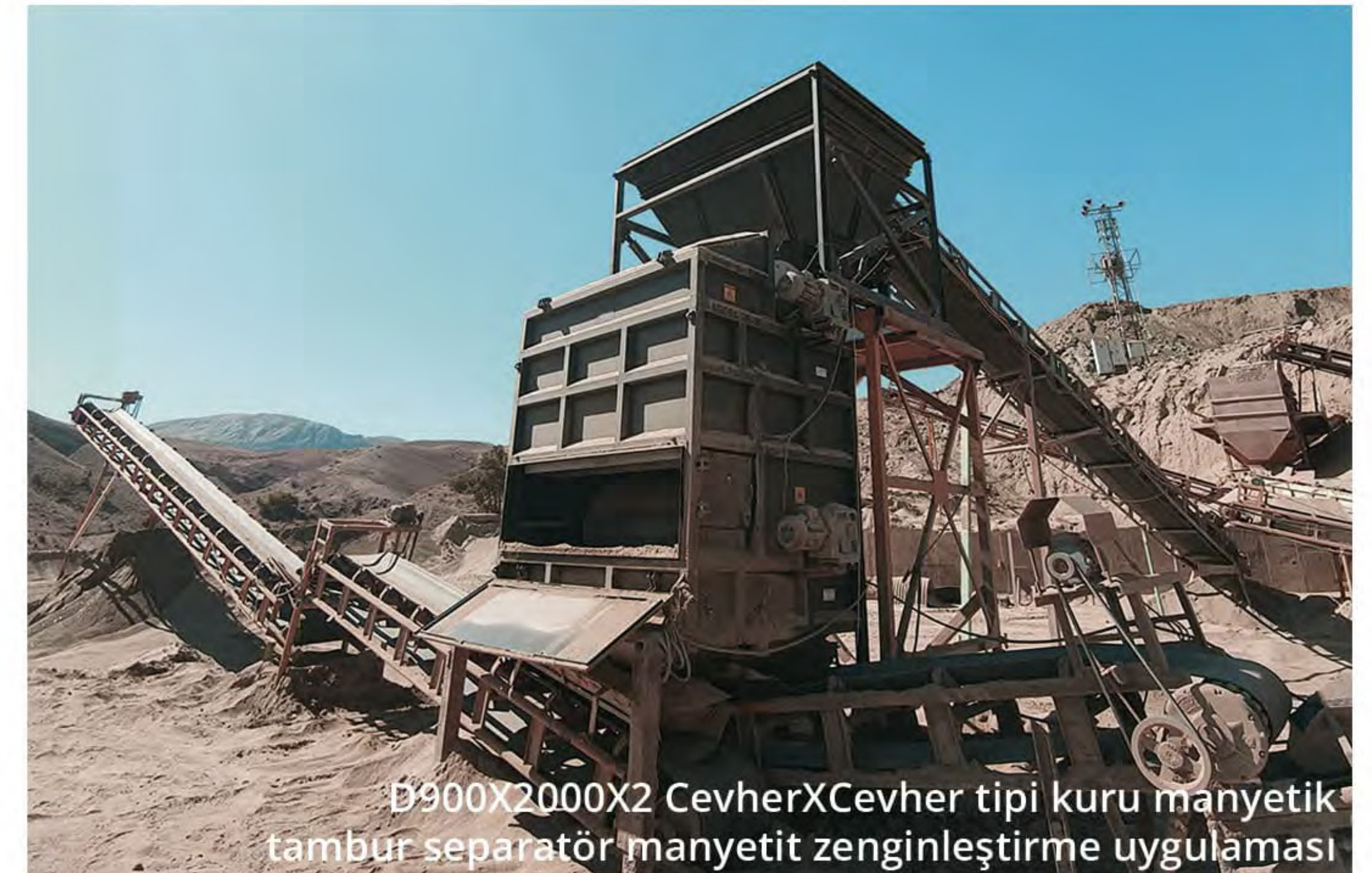
D900X2500X2 CevherXCevher tipi kuru manyetik tambur separatörler manyetit zenginleştirme uygulaması
