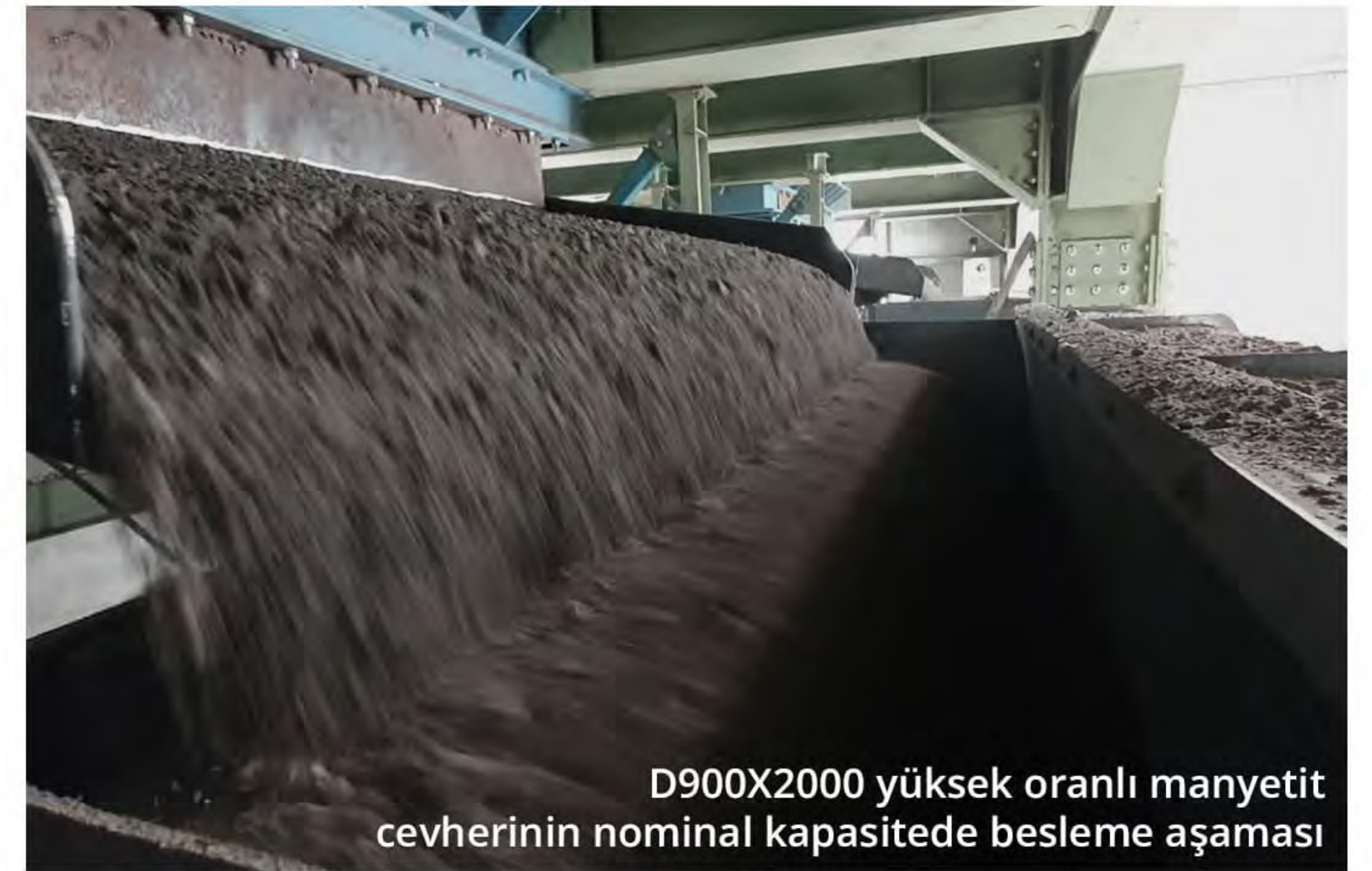
Yüksek tenörlü cevher zenginleştirme amacıyla kurgulanmış D900X1500 iki kademeli kuru manyetik tambur separatörler
