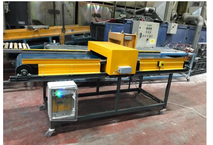
T6nel Tip Metal Dedekt6r ve Konvey6r Uygulaması
