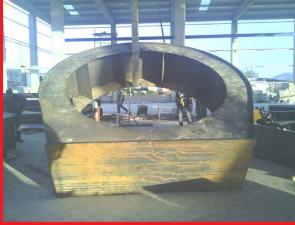
Çimento Fabrikası Sıcak Gaz Borusu Bağlantı Desteği
