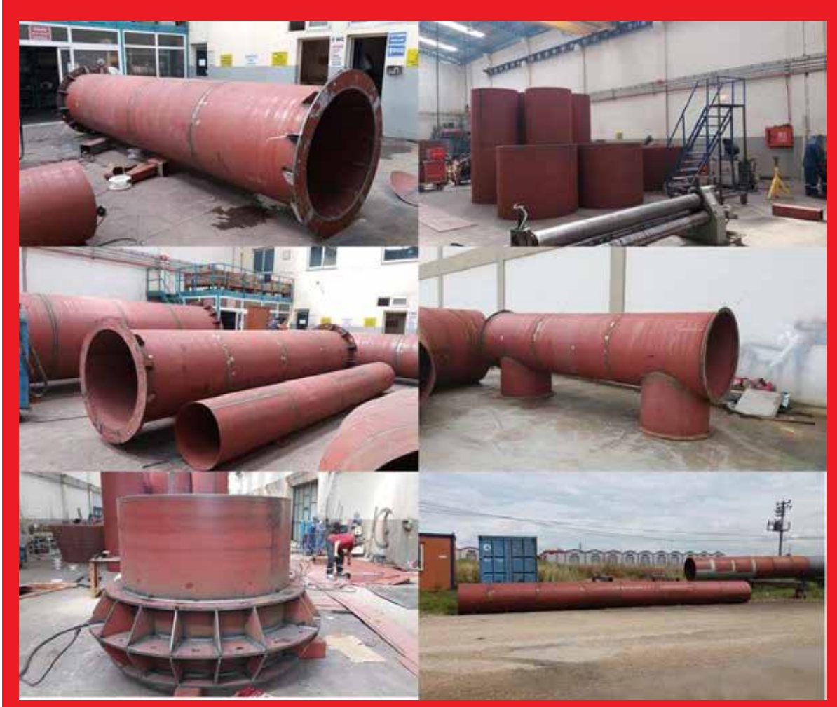
Demir Çelik Fabrikası Sıcak Gaz Borusu
