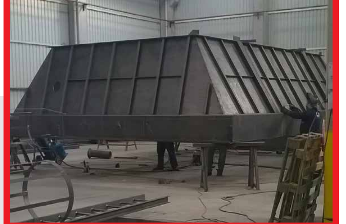
Çimento Fabrikası Filtre Bunkeri
