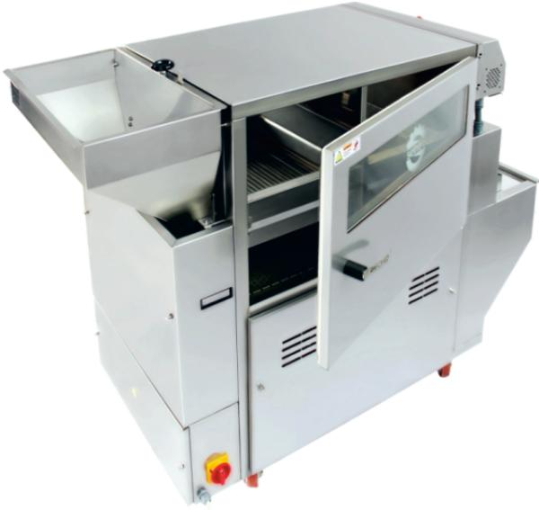
Güçlü hava sirkülasyonu sayesinde hızlı ve homojen kavurma elde edilmektedir. Kavurma sıcaklığı, bant ilerleme hızı ve ürün kalınlığı değerlerinin sayısal olarak ayarlanabilmesi sayesinde, her seferinde standart kavurma ile istenilen renk ve aromanın elde edilmesi sağlanır.
