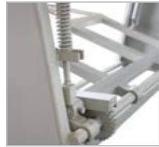
Yaylı pedal + Dişli sistemi ile kolay kesim Easy Operation by Spring + Gear supported Foot Pedal
