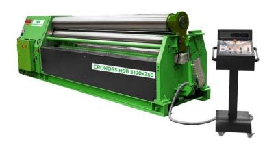
MOTORIZED CYLINDER BENDING MACHINE
