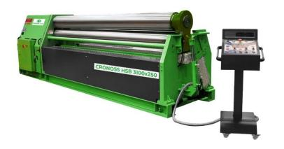
MOTORIZED CYLINDER BENDING MACHINE
