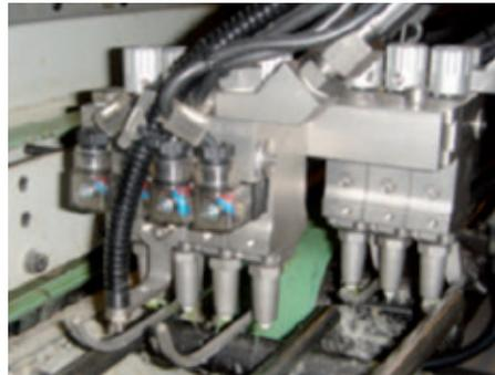
Modüler GTE-13/M: önde tek blokta 4 adet tutkal tabancası, arkada 3 adet tabancası; nozzle lar arasındaki mesafeyi ayarlamak için hareketli bir ray ile monteli
