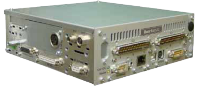
Makinenin çerçevesine veya elektrik panosuna yerleştirilecek emniyet kutulu MD2 ünitesi
