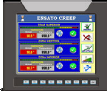
Test Ekranı, 3 bölgelerin ısıtılması
