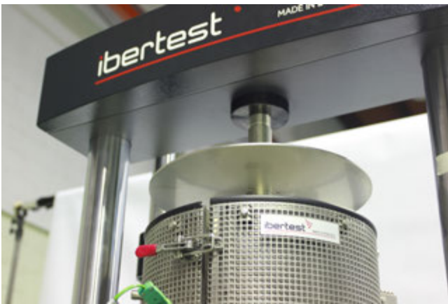
IB-CREEP küresel yataklı üst çaprazkafa ve yeni fırın.
