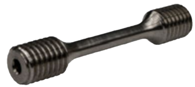
Sürünme testi için tipik çelik numunesi
