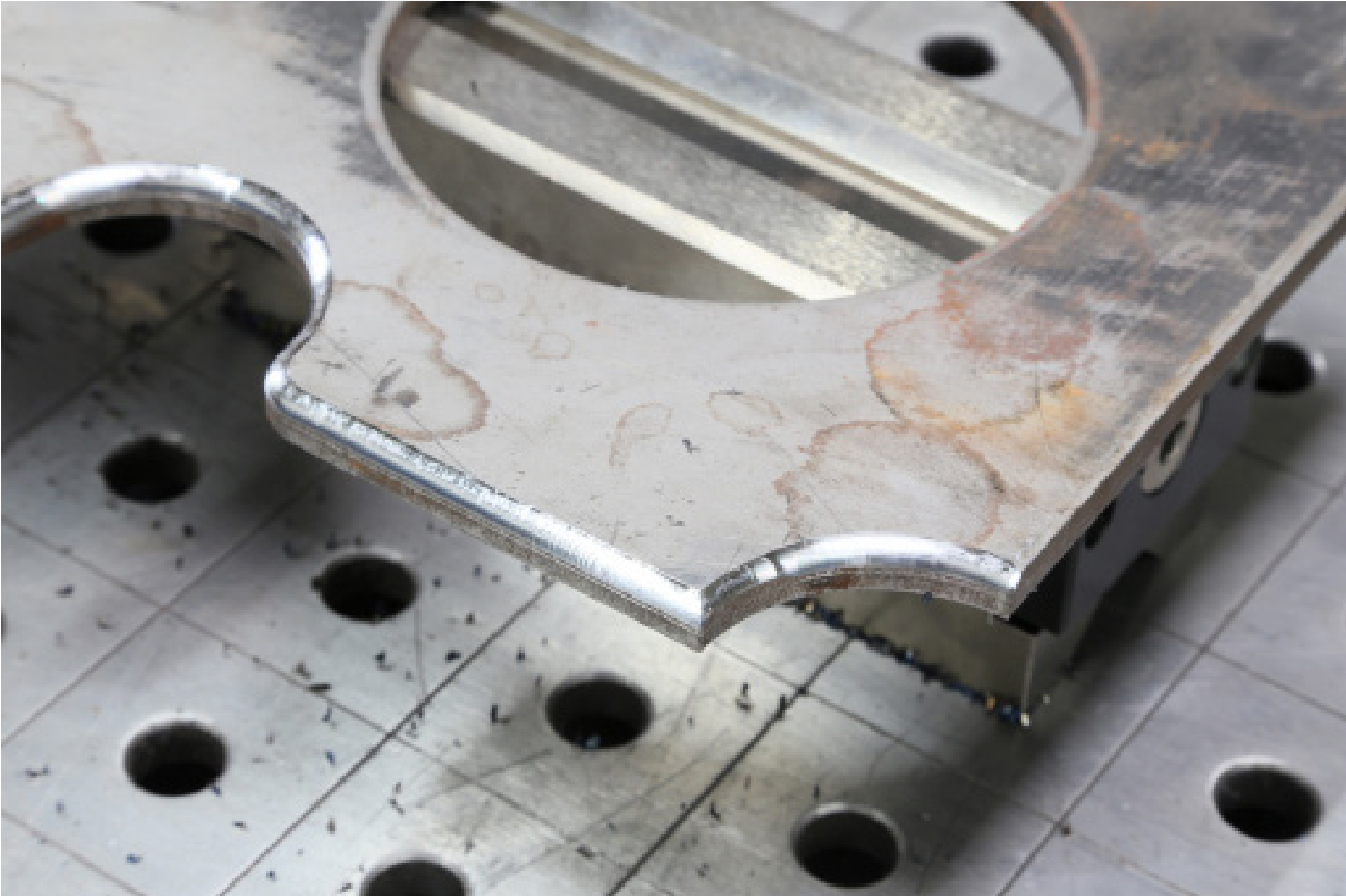
TAG PMM155 min 1.5mm sac kalınlığı
