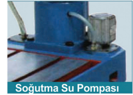
Soğutma Su Pompası
