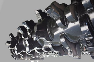
ÖZEL TASARIM 34 BİÇAKLI ROTOR DÜZENİ
