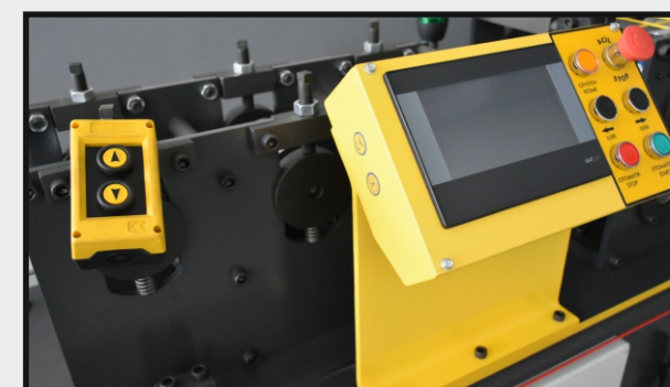
UZAKTAN KUMANDA Uzaktan Kumanda ile ileri geri hareket
