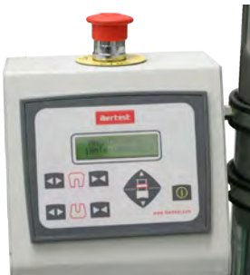
UCRB: Çeneleri açmak/kapatmak için Uzaktan Kumanda ve piston konumlandırma
