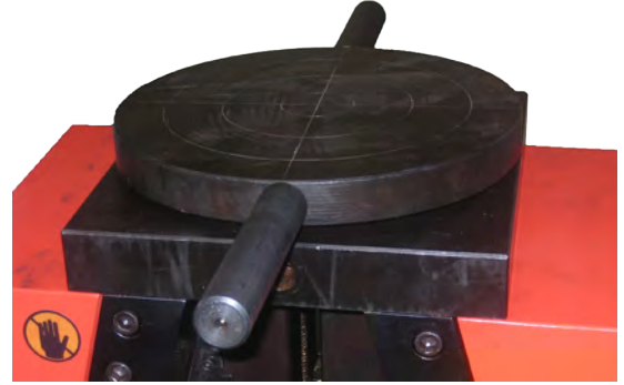
Hidrolik kavrama üzerine monte edilmiş sıkıştırma plakası
