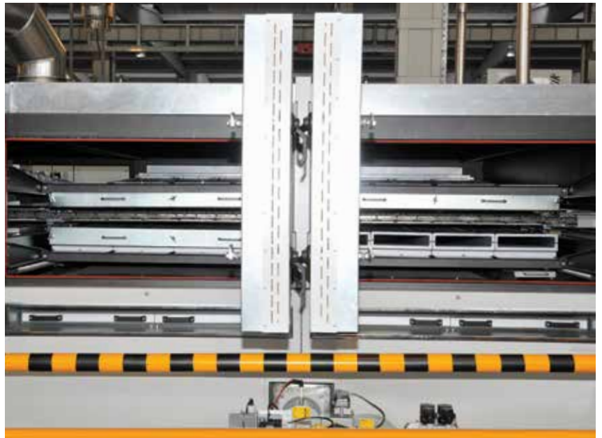
Uçları açılabilen hava kanalları ile kolay ve hızlı düze temizliği
