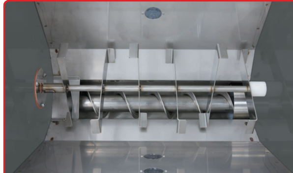
TALAŞ TOZU DOZAJLAYICI Akışkan olmayan malzeme dozajlamada kullanılır
