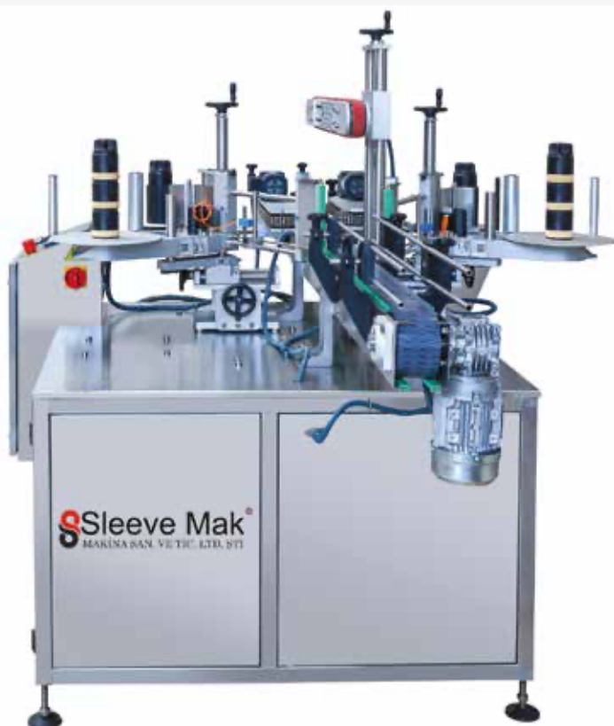
Двухсторонняя этикетировочная машина (SVM-LM002)
