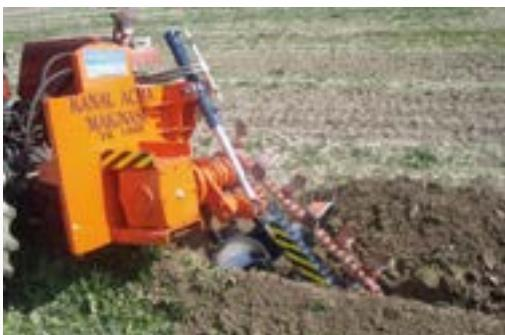
Damlama sulamada Pe,Pvc kantal ve benzeri boruların yeraltına gömülmesinde kullanılır.
