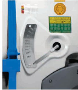
Seviye göstergesi sayesinde traktörden seviye takibi.
