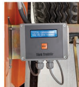
5 Elektronik ve mekanik balya sayacı
