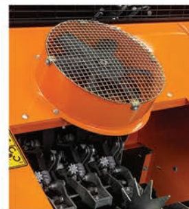
6 Açılır kapanır fan ile daima temiz bağlama grubu.
