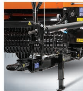
2 Şaft sabitleyicisi ile daha kolay şaft bağlantısı.
