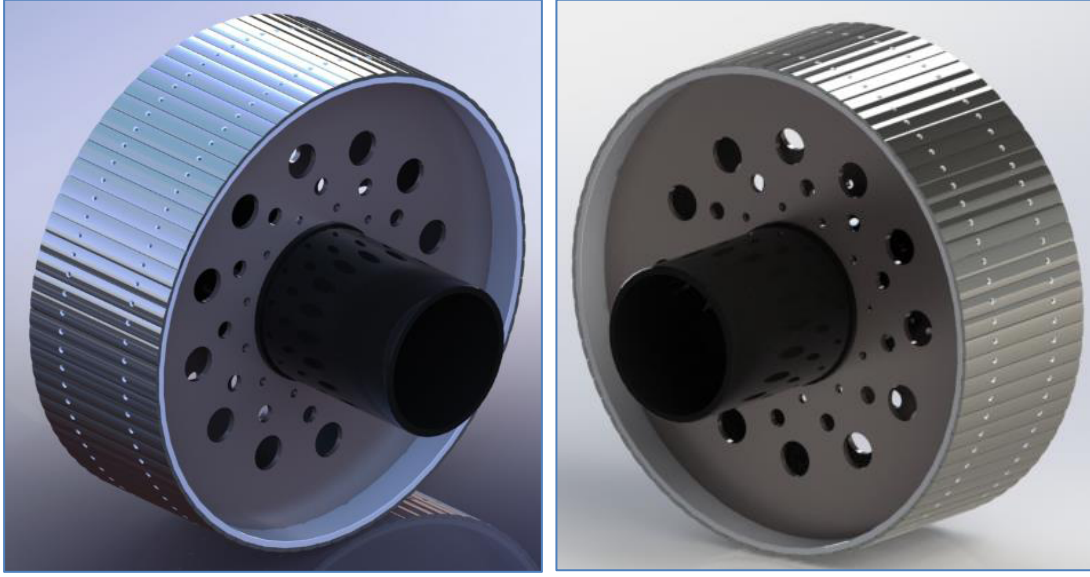
Şekil 30. Rotor ve mıknatıs birleşimi
