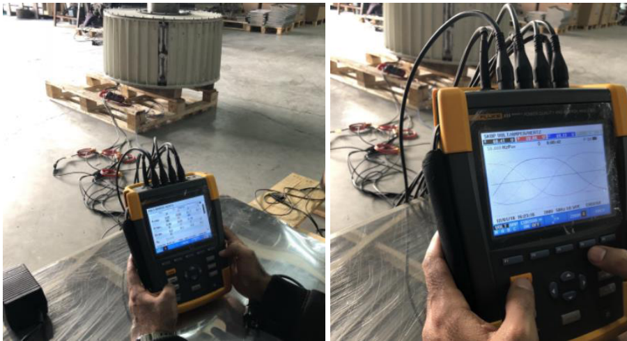
Şekil 39. Enerji analizöründen elde edilen görüntüler
