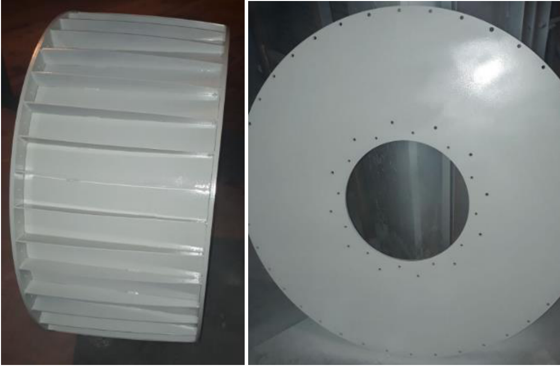
Şekil 36. Gvde ve kapakların boyanması
