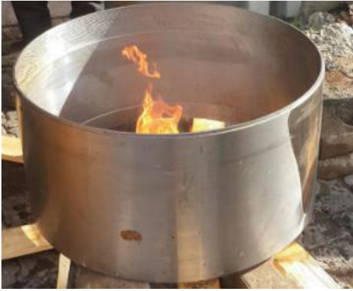
Şekil 34. Stator ve gövdenin entegrasyonu
