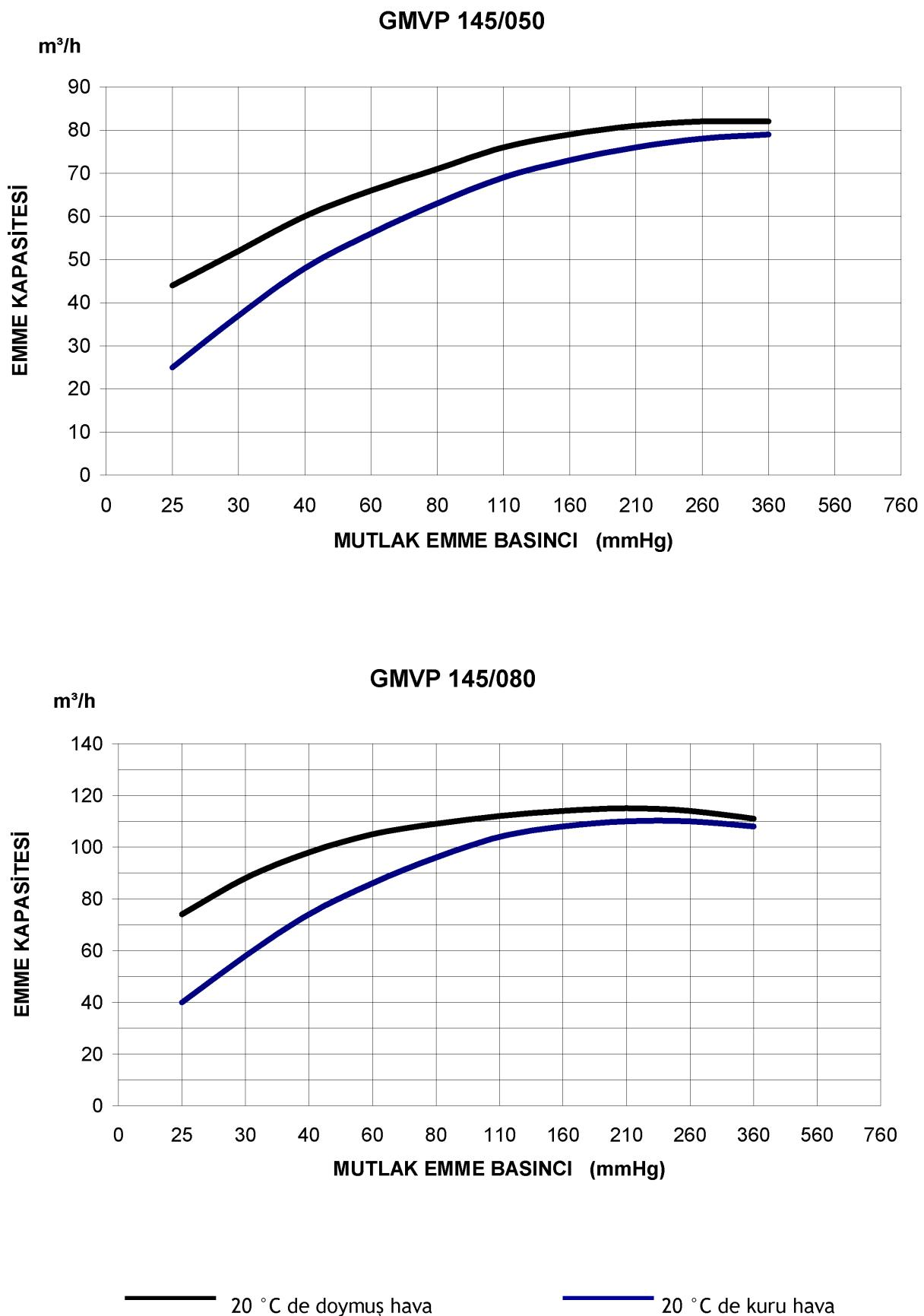
Grafikte gösterilen kapasiteler 760 mmHg atmosfer basıncında 15 °C sıcaklığındaki servis suyu için geçerlidir. Eğrilerin toleransı %10 dur.
