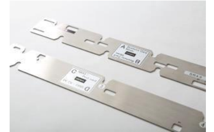
Slit bıçaklarının pozisyonunu değiştiren mekanik programlı şablonlar
