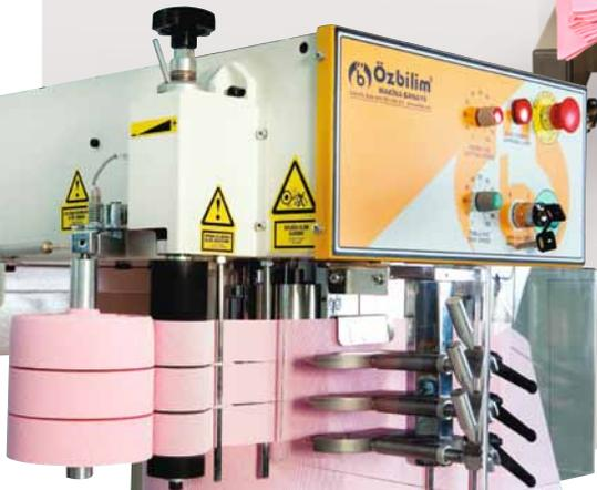
**RU** BK1 – BK2 АВТОМАТИЧЕСКАЯ МАШИНА ДЛЯ СРЕЗКИ СПЛОШНОЙ ПОЛОСКИ
